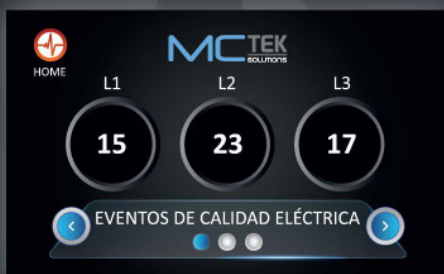
Registro de eventos de calidad eléctrica por línea
